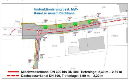
Der bestehende Mischwasserkanal wird für die künftige Dachentwässerung genutzt und ein neuer Mischwasserkanal wird über die komplette Straßenlänge verlegt. Somit sind auch sämtliche Hausanschlüsse im Gewerbegebiet zu erneuern.
